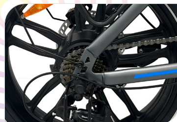
Motore Sutto Bafang, 250 W, 48V, 70 Nm
