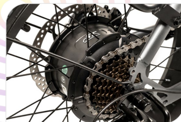
Motore Sutto Bafang, 250 W, 55 Nm
