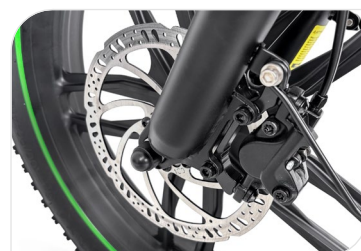
Freni a disco idraulici con cut off
